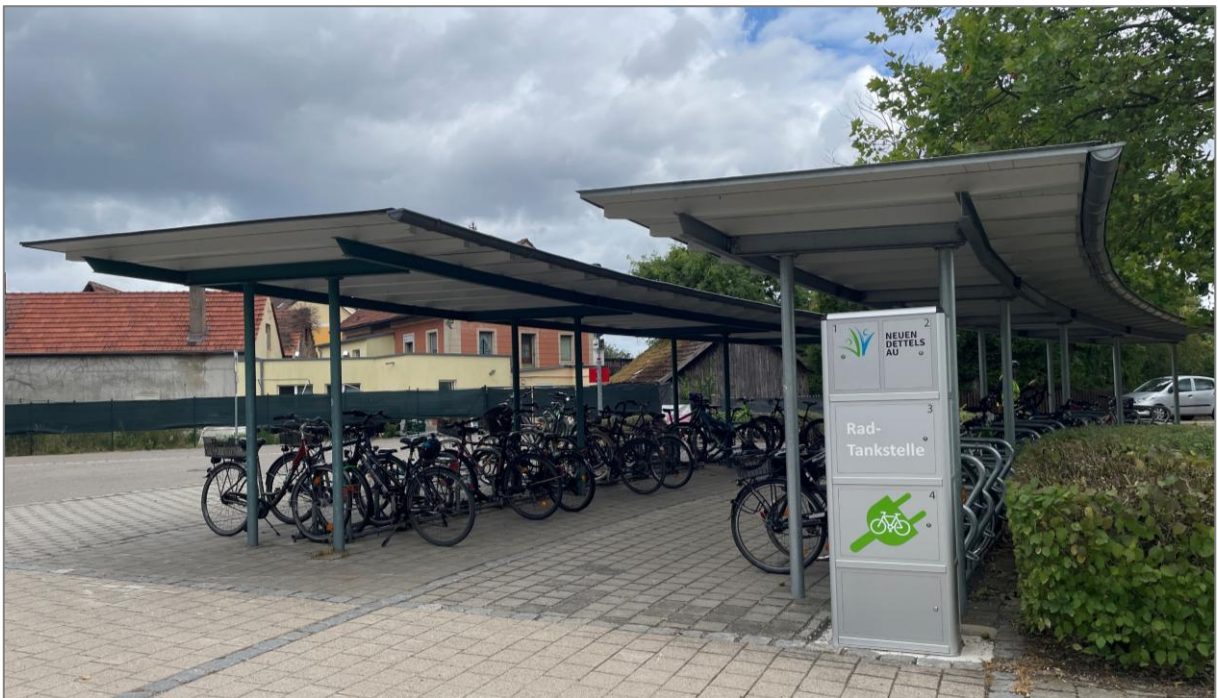
Abbildung 57: Beispielhafte Fahrradabstellanlage mit Schließfächern zum Laden von E-Bike-Akkus am Bahnhof Neuendettelsau
